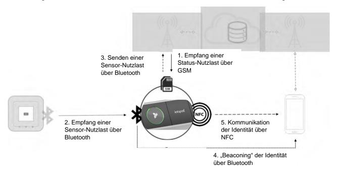
Abbildung 1. Erläuterung des iotspot-Moduls und seiner sechs Funktionen.
